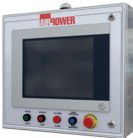
Quadro di controllo comandi con protezione IP 65, interfaccia utente touch-screen da 15" assistito da PLC. Comunicazione via cavo di rete ethernet da remoto.
