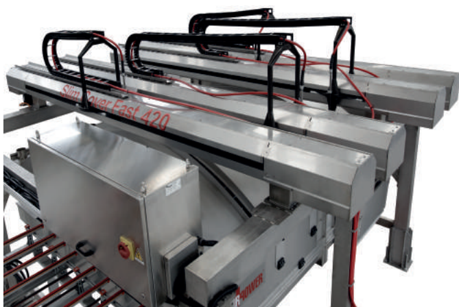
Formato multi-asse con traslatori superiori separati e braccio di sostegno in carbonio.
