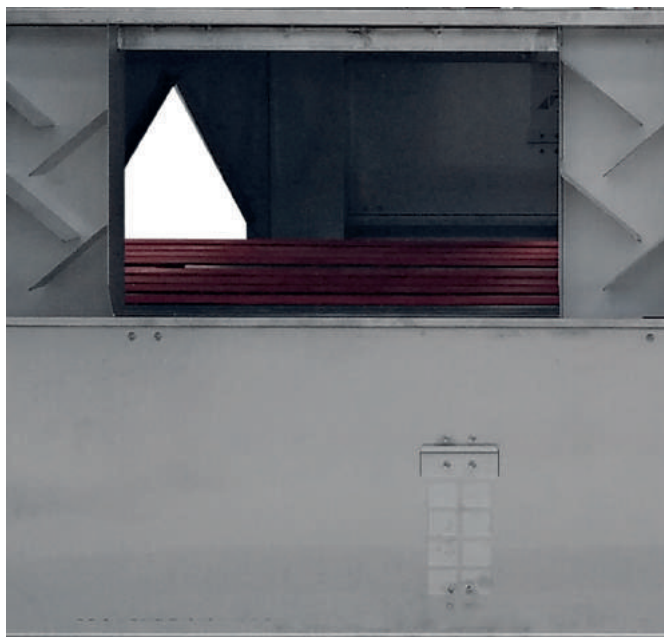
Cabina ispezionabile tramite apertura laterale fronte/retro, permette il lavaggio interno manuale.
