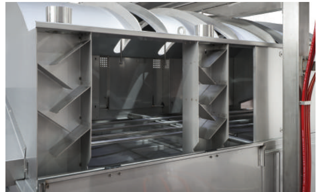
Cabina ispezionabile tramite apertura laterale. Cabin inspection through side opening.
